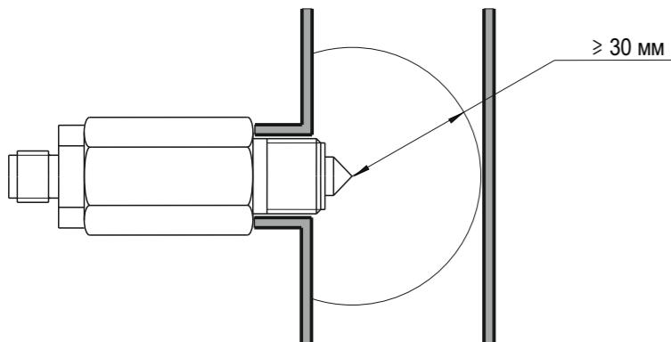
Длина штуцерного ввода должна быть подобрана таким образом, чтобы конус датчика выступал за край емкости.
